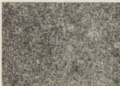
Rys. 27. Mikrostruktura MnNi_{0,05}/Ni - szczawian niklawy/spiekanego przez 3 godz. w temperaturze 1200^{\circ}C Pow. 250x
