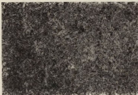
Rys. 6. Mikrostruktura Mo spiekane go przez 0,5 godz. w temperaturze 1200°C Pow. 250x
