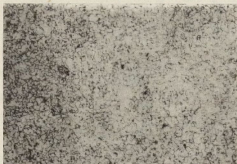
Rys. 8. Mikrostruktura MoNi_{0,4} /Ni - szczawian niklawy/ spiekane go przez 0,5 godz. w temperaturze 1200°C Pow. 250x
