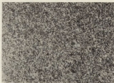
Rys. 25. Mikrostruktura MnO spiekanego przez 3 godz. w temperaturze 1400^{\circ}C Pow. 250x
