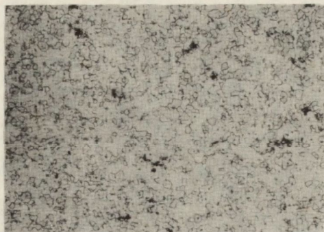
Rys. 29. Mikrostruktura \text{MoNi}_{0,4}/\text{Ni} - - szczawian niklawy/ spiekane- nego przez 3 godz. w tempera- turze 1200^{\circ}\text{C} Pow. 250x
