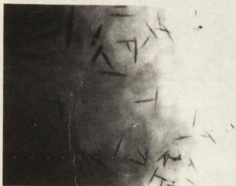
Rys. 8. Wydzielenie w formie igiełek. Warstwa zanieczyszczona miedzią (powiększenie 9600x).
