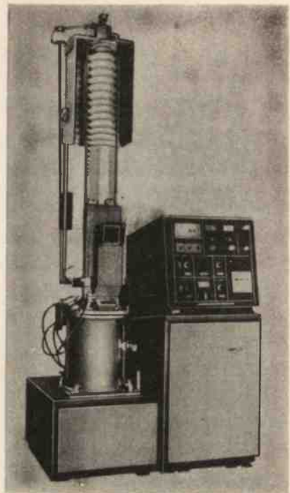
Rys. 9. Urządzenie do monokryształizacji krzemu metodą CZ firmy Kokusai
