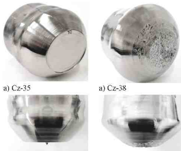
Rys. 6. Porównanie kształtu zakończenia kryształów: a) proces zakończony wcześniej (w tyglu zostało \sim 100 g wsadu), b) wsad wyciągnięty niemal do końca (zostało 8 g). Fig. 6. Comparison of the shape of crystal ends when: a) the process was finished earlier ( \sim 100 g charge left in the crucible), b) almost the entire charge got crystallized ( \sim 8 g left).
