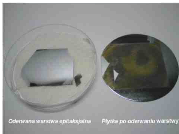
Rys. 18. Oderwana warstwa epitaksjalna o grubości 30 \mu\text{m} i płytka wyjściowa.
