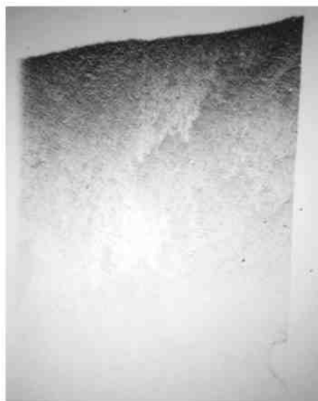
Rys. 9. Przykładowy topogram przekrojowy, naświetlony wąską poziomą wiązką o szerokości 5 \mu\text{m} w wiązce białej i odwzorowujący defekty z obszaru przecinanego wiązką. Szerokość pozioma odwzorowanego obszaru wynosi 7 \text{ mm} .
