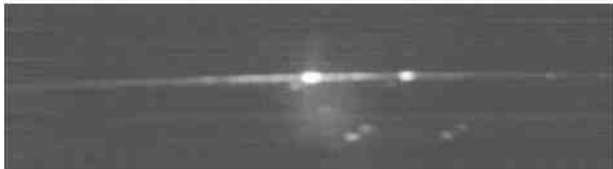
Rys. 11. Przykład uszkodzeń w strukturze wewnętrznej włókna PCF. Widoczne jasne punkty na włóknie wyraźnie zaburzają równomierność rozchodzenia się promieniowania pompy.
