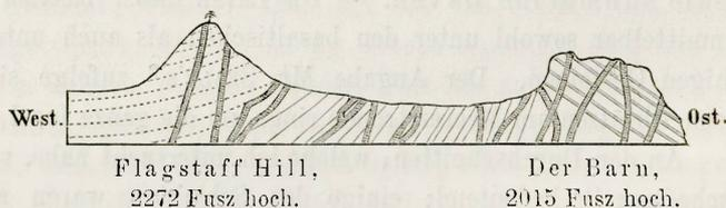
Fig. 8. Die doppelten Linien stellen die basaltischen Schichten, die einfachen die basalen submarinen Schichten dar, die punktirten die oberen feldspathigen Schichten, die Gänge sind quer schraffirt.
