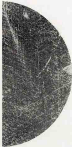
Rys. 2. Topografia transmisyjna warstwy epitaksjalnej krzemu o grubości 80 \mu\text{m}
