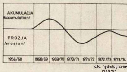
Ryc. 11. Względne natężenie erozji i akumulacji w korycie Wisły w strefie profilu wodowskazu Włocławek
