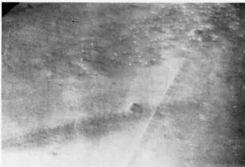
Rys. 5. Topografia transmisyjna cieńszej warstwy epitaksjalnej /w porównaniu z rys.4/, lecz o tym samym niedopasowaniu sieciowym m /jak na rys. 4/, układ +m, -n /pow. 15x/
