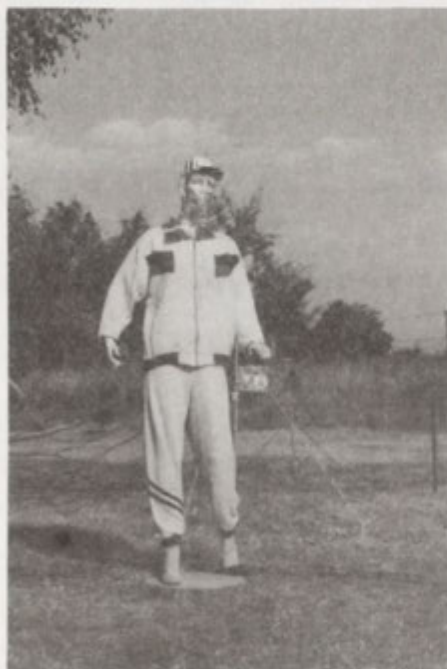
Fot. 1. Manekin, jako geometryczny model człowieka; badania ilości pochłoniętego promieniowania słonecznego; a — widok z przodu, b — widok z tyłu, widoczne czujniki strumienia ciepła
