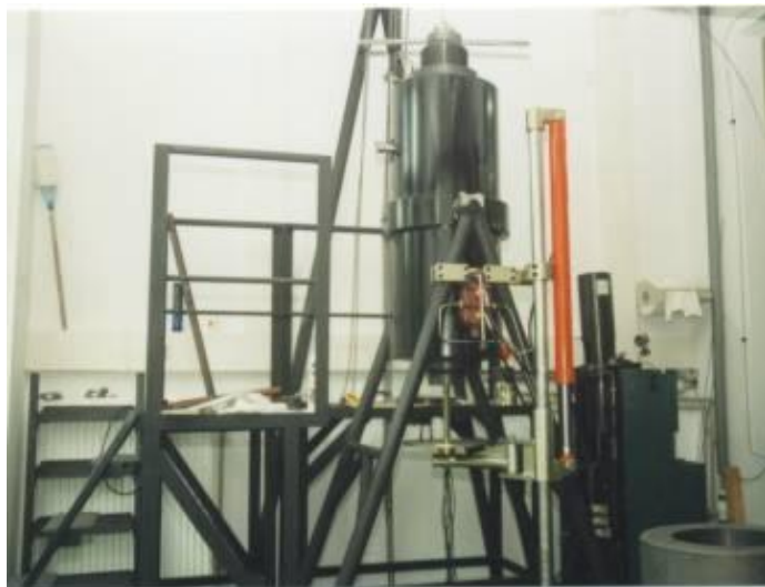
Rysunek 22. Zdjęcie komory wysokociśnieniowej, do wzrostu monokryształów GaN
