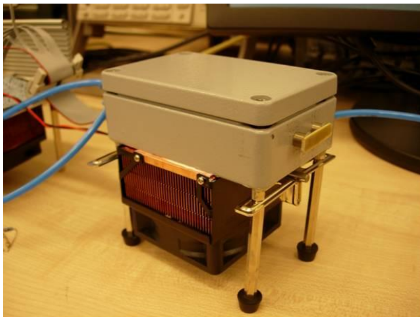
Rysunek 52. Moduł laserowy do testów w warunkach kontrolowanego przepływu gazu. Widoczne wloty i wyloty gazu (niebieskie rurki).
