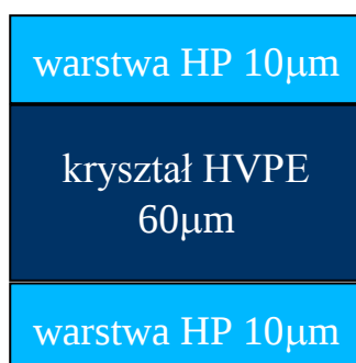
Rysunek 61. Struktura podłoża użyta w badanych laserach.
