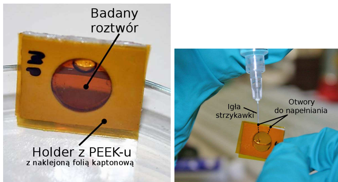
Rysunek 2.5. Holder cieczowy. Po lewej fotografia holderu oklejonego taśmą kaptonową oraz wypełnionego badanym roztworem. Na górnym brzegu holderu widoczna jest warstwa kleju, którym zaklejono otwory do wprowadzania roztworu i wyprowadzania powietrza. Po prawej fotografia wykonana podczas napełniania oklejonego taśmą kaptonową holderu przez jeden z otworów w holderze.
