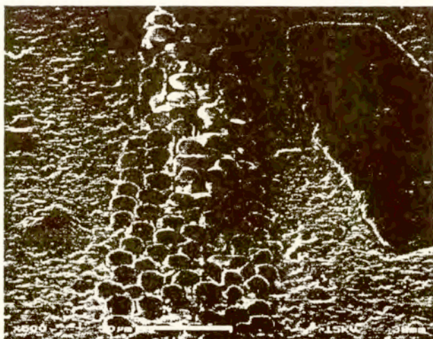
Rys. 7.6 Mikrofotografia SEM fragmentu pasma włókien szklanych w próbce zaprawy zawierającej 30% metakaolinu wg Tablicy 6.2 w wieku 28 dni (pow. 500x, podziałka = 50 \mu m)
