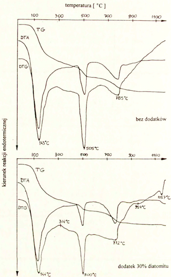
Rys.Z1.3 Termogram próbki zaczynu z cementu białego bez dodatków (a) i zawierającego 30% diatomitu (b)
