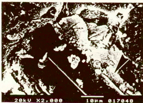
Rys. 6.6 Mikrofotografia przełomu próbki serii nr 46 (dodatek 40% metakaolinu, po starzeniu) oraz spektrum EDX w miejscu wskazanej strzałką (CSH - uwodniony krzemian wapnia)
