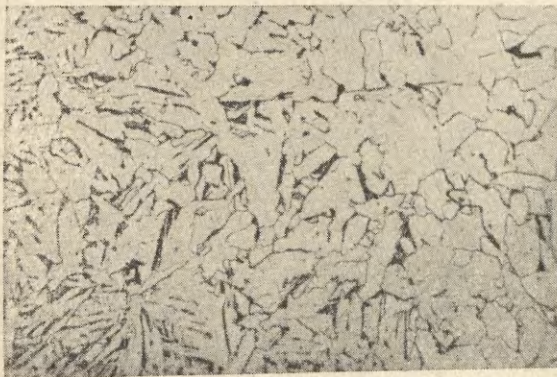
Ryc. 14. Struktura fragmentu z Kornatki w miejscu nawęglonym: ferryt, ślady perlitu i wtrącenia żużla, traw. azotalem, pow. 100 ×
