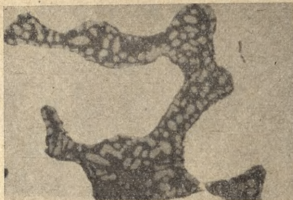
Ryc. 15. Struktura wtrąceń żużla we fragmencie żelaznym z Kornatki, nietraw., pow. 500 X
