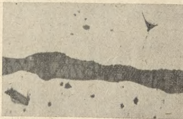
Ryc. 11. Struktura wtrąceń żużla w nożu nr 1 z Winiar, nietraw., pow. 500 ×
