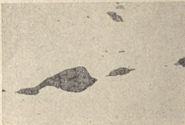
Ryc. 9. Wtrącenia żużla z noża nr 2 z Trzebiesławic, nietraw., pow. 500 ×
