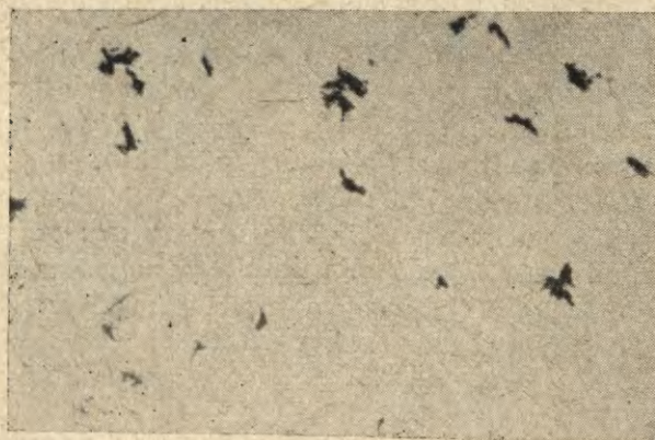
Ryc. 14. Wtrącenia żużla w szpili (?) nr 2 z grobu nr 168, nietraw., pow. 500 ×
