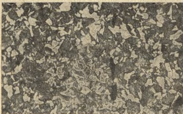
Ryc. 5. Struktura noża nr 1 z grobu nr 135 pod większym powiększeniem: ferryt, sorbit i wtrącenia żużla. Traw. azotalem, pow. 500\times
