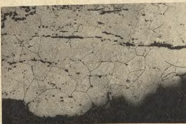
Ryc. 8. Struktura szpili nr 1 z grobu nr 147: ferryt i wtrącenia żużla, traw. azotalem, pow. 100 ×
