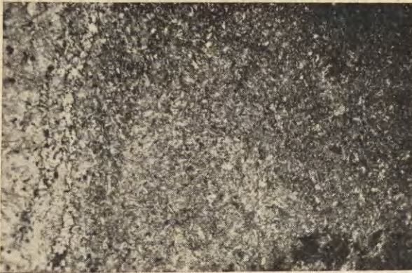
Ryc. 15. Struktura szpili (?) nr 2 z grobu nr 168: martenzyt, ślady ferrytu i wtrącenia żużla, traw. azotalem, pow. 100 ×
