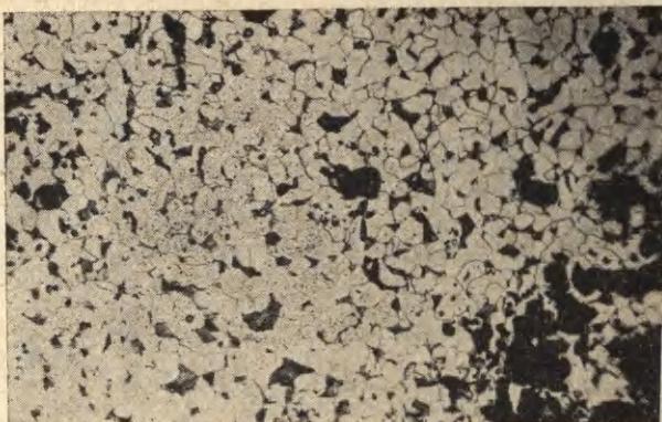
Ryc. 3. Struktura bransolety nr 1 z grobu nr 109: ferryt, perlit, wtrącenia żużla oraz ślady postępującej korozji. Próbkę trawiona azotalem, pow. 100\times
