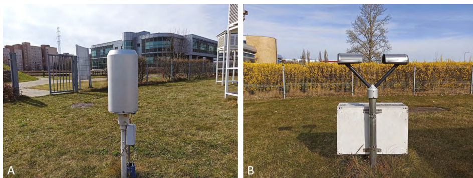
Fot. 1. Deszczomierz korytkowy (A) i disdrometr Parsivel1 (B) na stacji meteorologicznej SGGW (fot. M. Barszcz) The tipping-bucket rain gauge (A) and a Parsivel1 disdrometer (B) at the WULS-SGGW Meteorological Station
