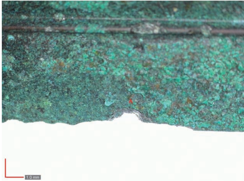
Ryc. 5. A – asymetryczne wcięcie otoczone przez partię przemieszczonego materiału. Powiększenie 30-krotne Fig. 5. A – Asymmetrical notch surrounded by a piece of displaced material. Magnification: 30 x
