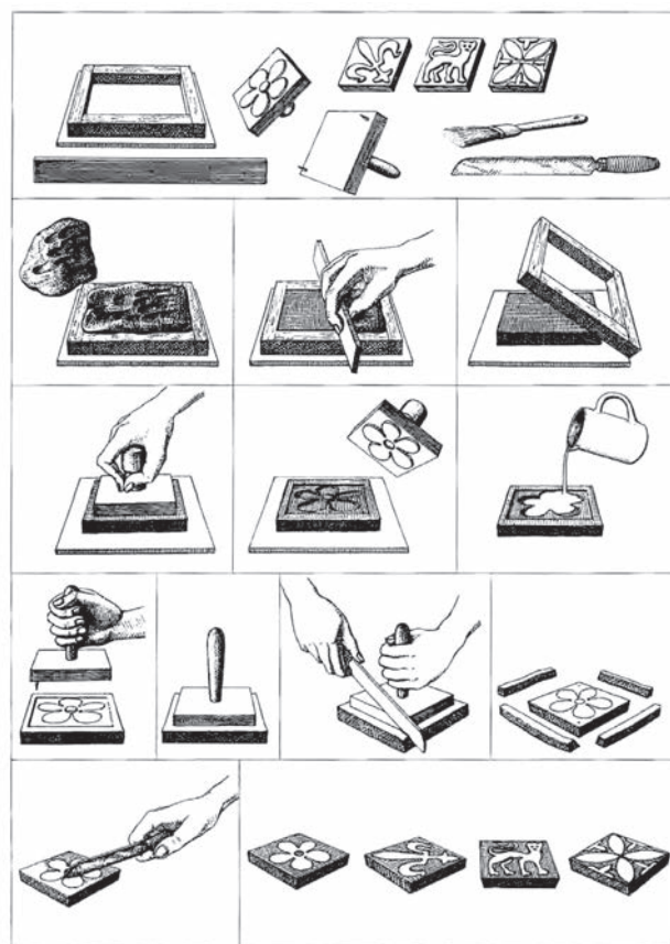
Ryc. 39. Etapy średniowiecznej produkcji ceramicznych płytek posadzkowych w technice reliefowo-inkrustacyjnej. Wg NIEMIEC 2016, ryc. 29 (rys. J.-C. Barcon, za LANDGRAF 1993, t. 1)
