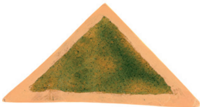
Ryc. 60. Szkliwo zestawione bez użycia tartego szkła
