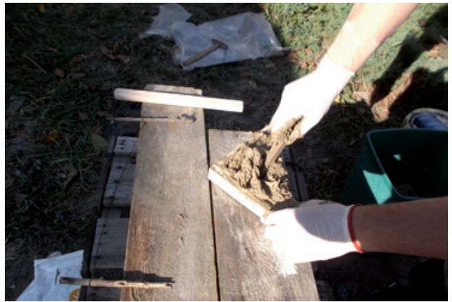
Ryc. 24. Formowanie trójkątnej płytki w formie zbijanej z desek, na stole formierczym posypanym piaskiem, przez A. Mielcarzewicza
