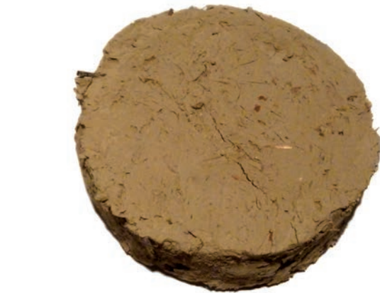
Ryc. 19. Płytką w formie, wygładzoną strychulcem, 19a – wygładzona tkaniną zanurzoną w glinie, wysuszona i wyjęta z formy
