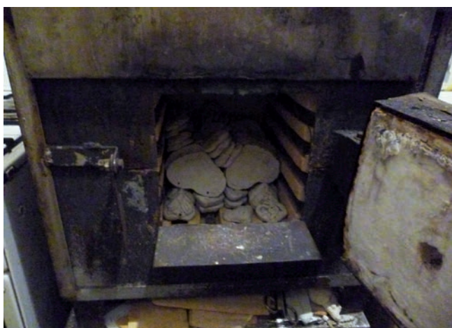
Ryc. 40-41. Elektryczny piec do wypału ceramiki M. Peczyńskiego
