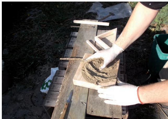
Ryc. 15. Formowanie płytki okrągłej, w drążonej formie posypanej piaskiem, przez A. Mielcarzewicza
