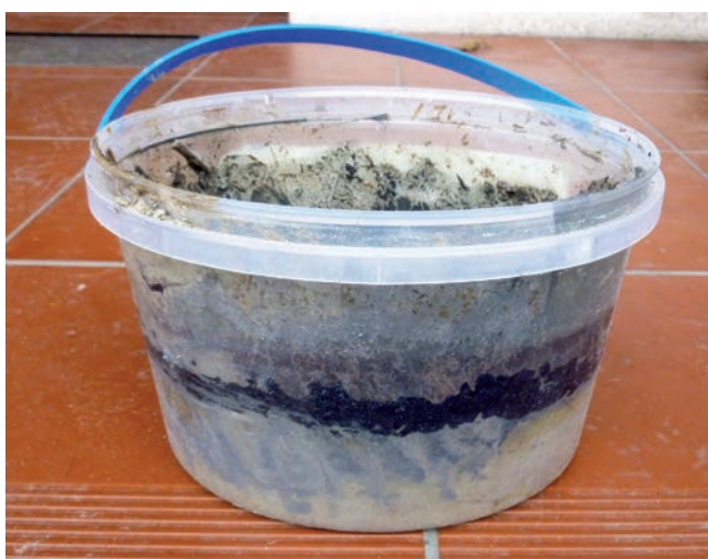
Ryc. 3. Dołowanie gliny – na zdjęciu zestaw z domieszką organiczną dodaną do gliny przed dołowaniem
