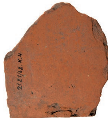
Ryc. 25. Fragment płytki posadzkowej ze szczeliną, powstała w wyniku niedokładnie ubitej gliny w formie (Kruszwica, stan. 4, nr kat. 548 zamek, nr inw. 2121)
