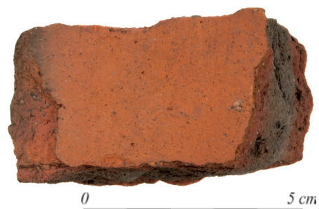
Ryc. 56. Niedopalona płytka posadzkowa (Kruszwica, stan. 4, nr kat. 255 gród, nr inw. 2344)
