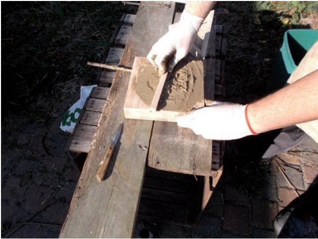
Ryc. 18. Wyglądanie powierzchni licowej za pomocą strychulca, przez A. Mielcarzewicza
