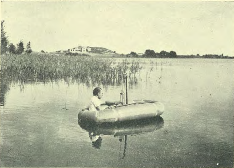
Łódź pneumatyczna z aparaturą do pobierania próbek wody głębinowej.
