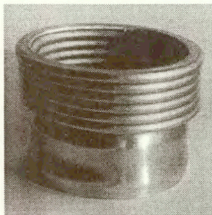
Rys. 2.26: Wynik eksperymentu dynamicznego zgniatania cylindra.
