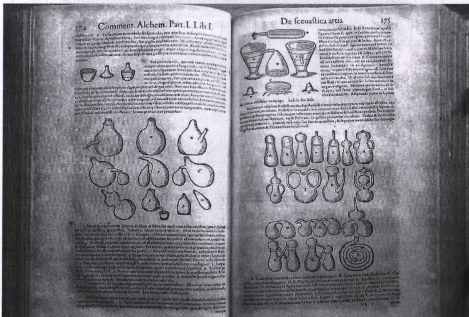
Ilustracja 10. Na dole: „pelikan” w Alchimii Libaviusa (s. 175, litera I), czyli szklane naczynie alchemiczne służące do cyrkulacyjnej, długotrwałej destylacji w niezbyt wysokiej temperaturze.
