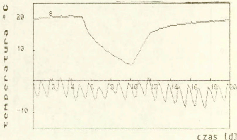
Wykres 4.30. Przebieg stygnięcia i ogrzewania bloku po awarii ogrzewania 5 i usunięciu jej 10 stycznia. Blok 8 - Warszawa.
