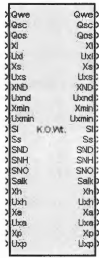
Rysunek 3.11. Graficzne przedstawienie bloku warstwy osadnika wtórnego
