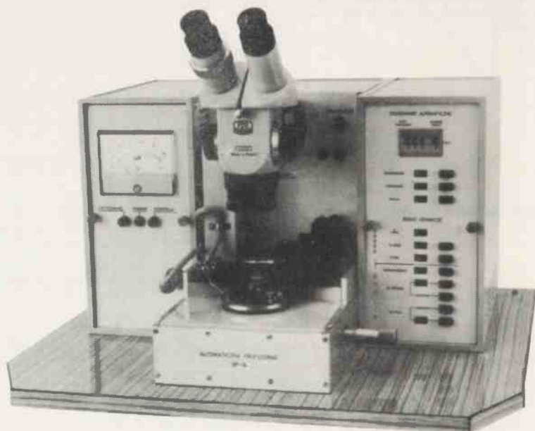
Rys. 11. Półautomatyczne stanowisko do pomiaru szerokości warstwy rozmytej metodą rozptyłu oporu
