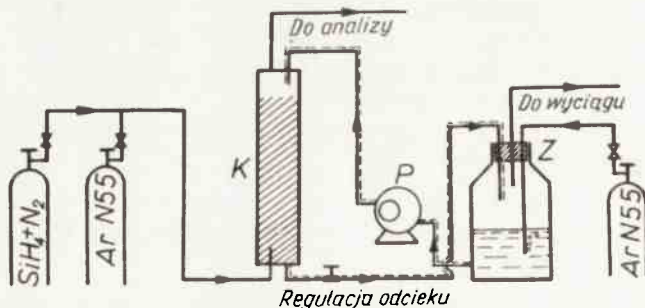
Rys. 1. K - kolumna absorpcyjna; P - pompka perystaltyczna; Z - zbiornik z ługiem
