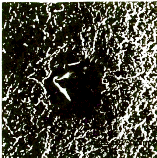
Rys.2.27. Kratery przebicia dielektrycznego w izolatorze świecy zapłonowej występujące wzdłuż mikropeknięcia na powierzchni izolatora. Elektronowy mikroskop skaningowy JEOL/JSM - 35, powiększenie 500 x [69].
