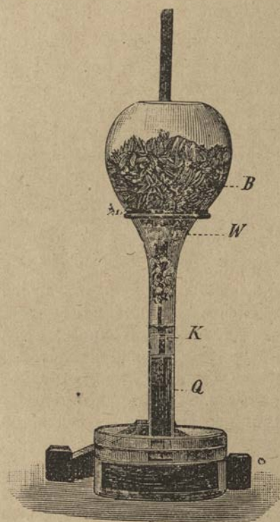
Рис. 83. Опыт над дыханием растений. Расширенная часть стеклянной колбы B наполнена корзинчатыми соцветиями Chrysanthemum . Выделяемая ими при дыхании углекислота поглощается раствором едкого кали K , вследствие чего ртуть Q проникает в трубку и поднимается в ней.
