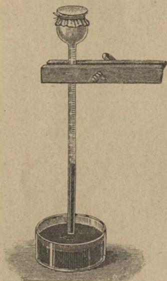
Рис. 241. Испарение воды через перепонку, вызывающее поднятие ртути в трубке.
