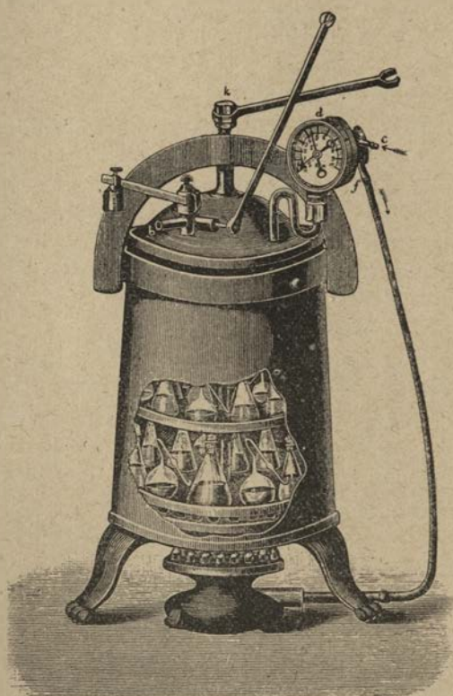
Рис. 82. Автоклав. Часть передней стенки удалена, чтобы показать расположение сосудов с стерилизуемыми растворами.
