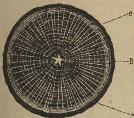
Рис. 183. Сердцевинные лучи и годовичные слои на поперечном разрезе 18-тилетнего ствола дуба. В центре звездообразная сердцевина.
