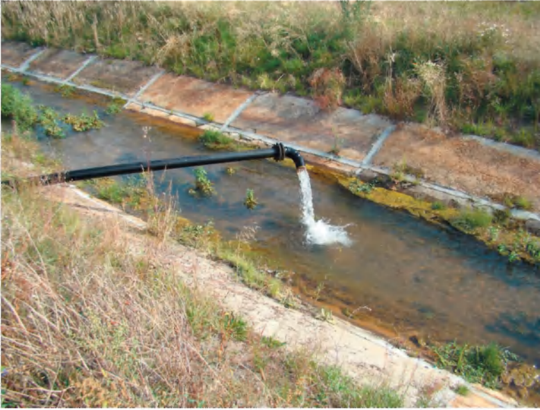
Fot. 3. Rurociąg odprowadzający wodę z odkrywki „Tomisławice” (wrzesień 2009 r.) (Fot. D. Brykała)
