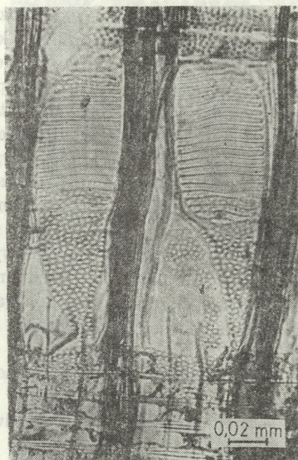
Ryc. 8. Drewno na przekroju promienistym. Drabinkowate przebiecia w naczyniach
