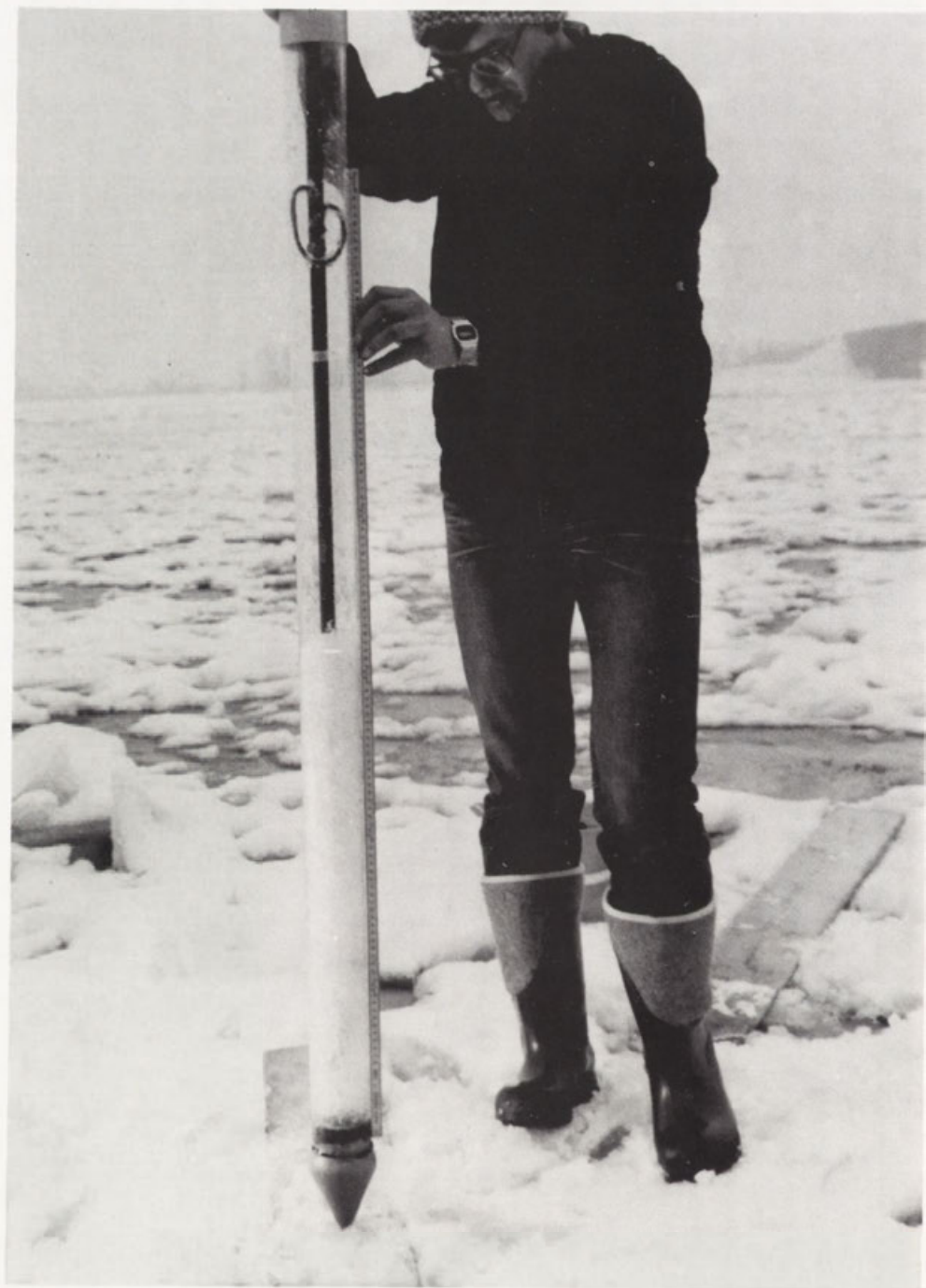
Fot. 35. Sonda śryżowa z zaworem stożkowym. Pomiar miąższości pulpy śryżowej po odsączeniu (porównaj ryc. 6).
