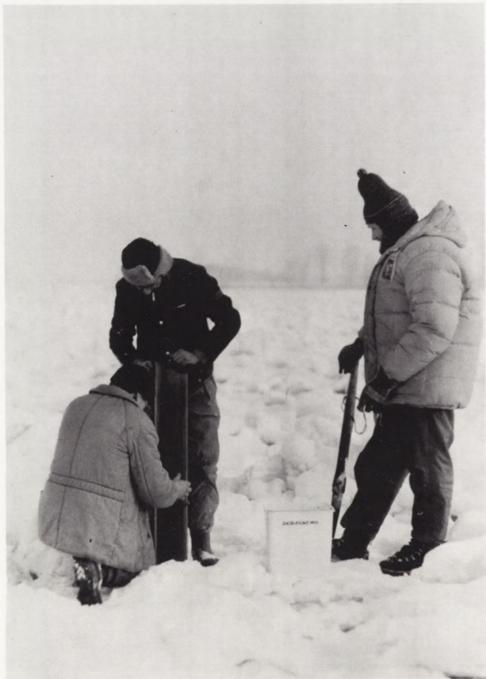
Fot. 37. Pobór próby za pomocą udarowej sondy z zaworem klepkowym (porównaj ryc. 8).
