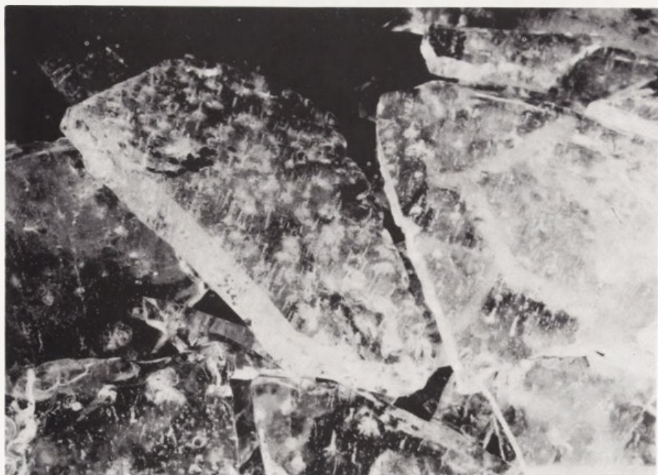
Fot. 15. Struktura wewnętrzna krystalicznej pokrywy lodowej (black ice). Zaawansowane selektywne topienie na granicy kryształów.
