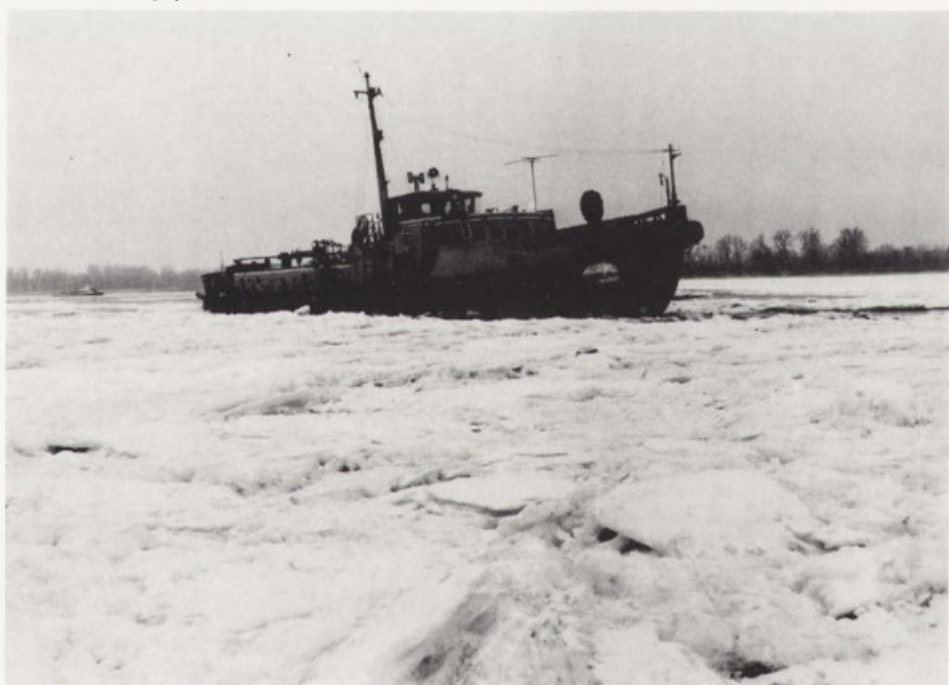
Fot. 49. Pracujący w czole zatoru (km 710) lodołamacz poniżej stopnia wodnego Włocławek (marzec 1985).
