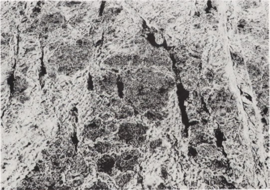
Fot. 2. Powierzchnia zabitki śryżowej w rejonie Dobrzykowa (km 622), grudzień 1983 (porównaj ryc. 21). Bardzo wyraźnie widoczny efekt kolizji (por. rozdz. 2) na kontakcie pól śryżowych. Pomiędzy polami śryżowymi „luki” we frontálním rozbudowywaniu pokrywy lodowej — płonie dynamiczne. Zdjęcie lotnicze.
