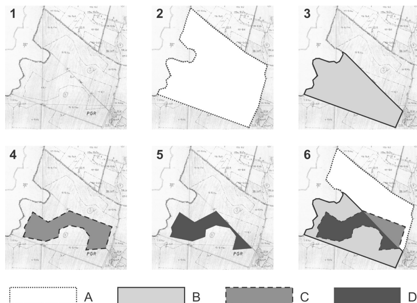
Ryc. 2. Podstawowe elementy rozłogu gospodarstwa. 1 – rozłóg gospodarstwa (wszystkie grunty); 2 – pole płodozmianu (jednostka uprawowa płodozmianu, obszar na którym uprawia się daną roślinę); 3 – działka ewidencyjna; 4 – użytek gruntowy (ciągły obszar gruntu, wyodrębniony ze względu na jednolity sposób użytkowania lub zagospodarowania); 5 – parcela (ciągła część powierzchni ziemi wyodrębniona według władania i użytkowania); 6 – podstawowe elementy rozłogu: A – pole; B – działka; C – użytek; D – parcela.
