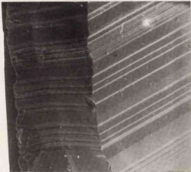
Rys. 26. Zespół podłużnych granic bliźniaczych widoczny na przełomie /z lewej/ i na powierzchni taśmy krzemowej /z prawej strony rysunku/, SEM /pow. 100x/
