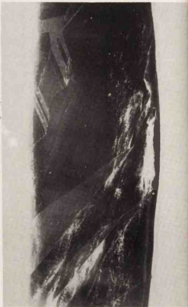
Rys. 35. Struktura polikrystaliczna taśmy krzemowej powstała w odległości 10 cm od zarodki /pow. 2x/
