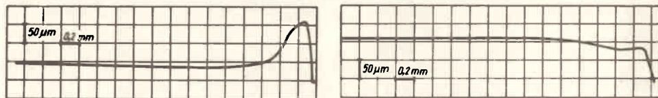
Rys. 2. Profil powierzchni płytki z warstwą epitaksjalną, z wystającą „koroną” a) płytka podłożowa z ostrymi krawędziami, b) płytka podłożowa z zaokrąglonymi krawędziami
