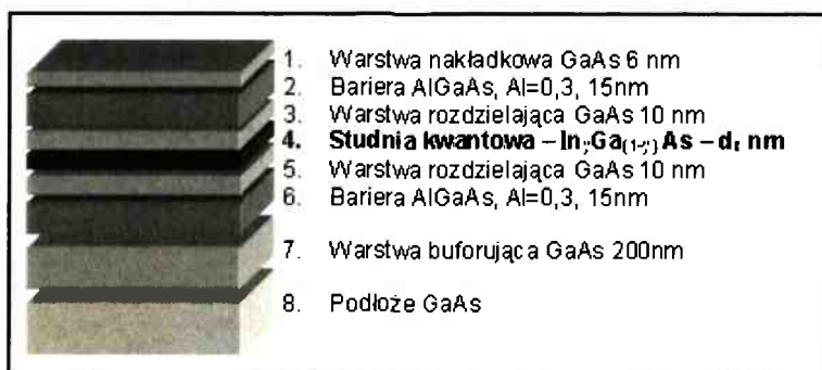
Rys. 3. 10. Schematyczny rysunek struktury nominalnej z dwiema barierami AlGaAs.
