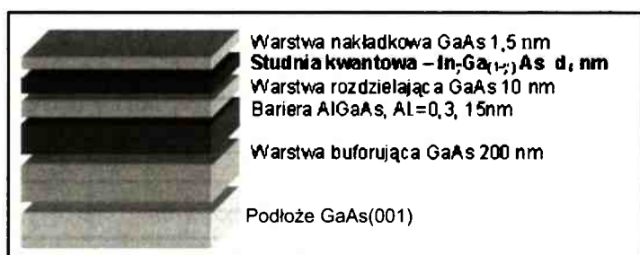
Rys. 3.8. Schematyczny rysunek struktury docelowej z jedną barierą AlGaAs.
