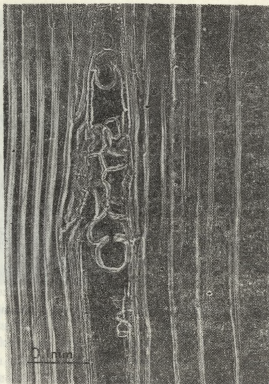
Ryc. 20. Fragment drewna pnia przy przejściu drewna wczesnego w późne z pionowym przewodem żywicznym wypełnionym tylozoidami, na przekroju promienistym
