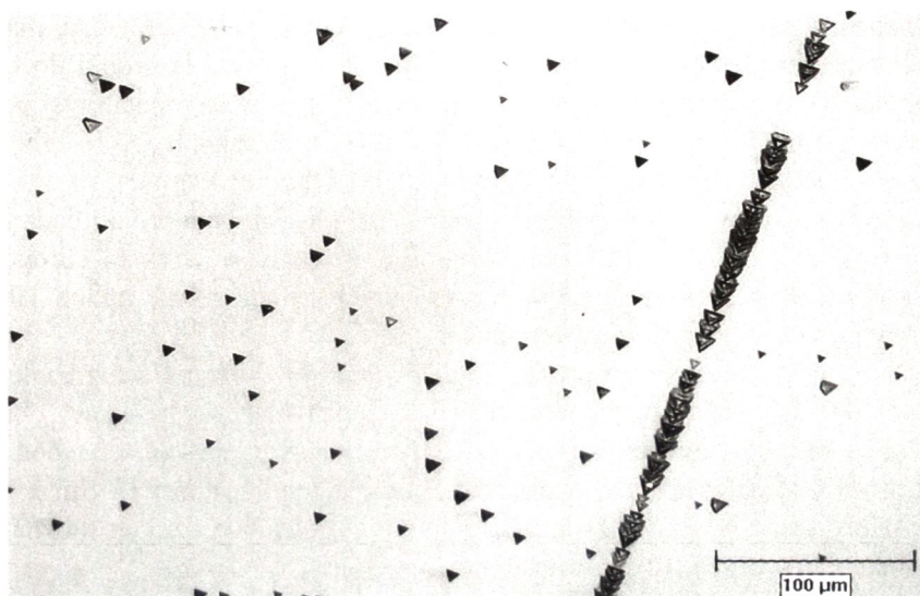
Rys.3. Mikroskopowy obraz jamek trawienia płytki (0001) szafiru. Wartość średnia EPD wynosi 6,1 \times 10^4 \text{ cm}^{-2} .
