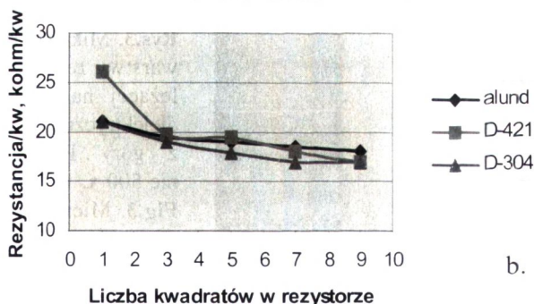
Rys. 2. a - Wzór testowy do badania rezystorów na warstwie dielektrycznej; b - Zależność rezystancji od długości rezystora dla rezystorów wykonanych z pasty \text{R-RuO}_2 i naniesionych na warstwy dielektryczne D-421 i D-304 oraz bezpośrednio na podłoże alundowe.
