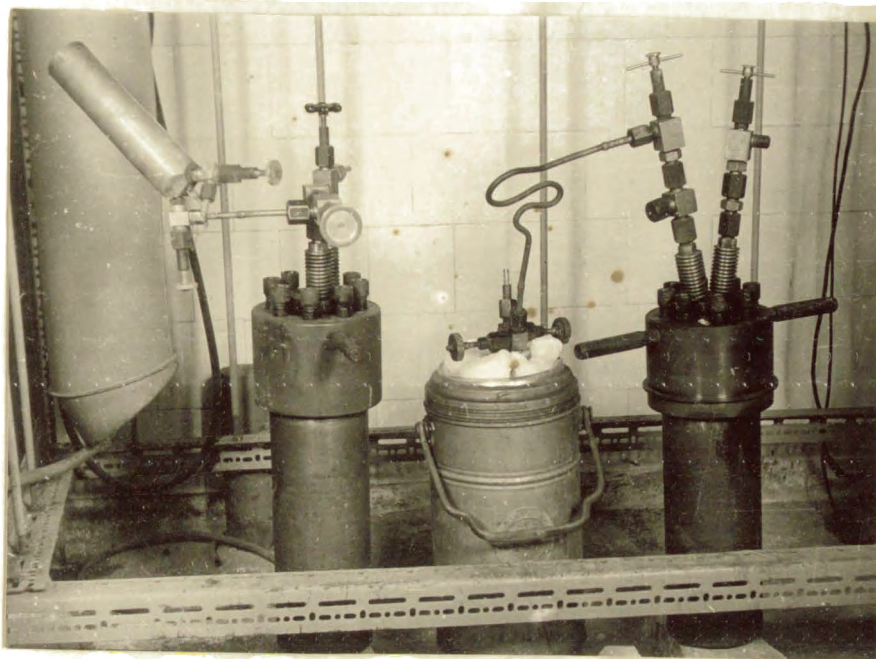
Rysunek 6.1. Sposób dozowania chloru do autoklawu oraz sposób odbioru wytworzonego SF 4
