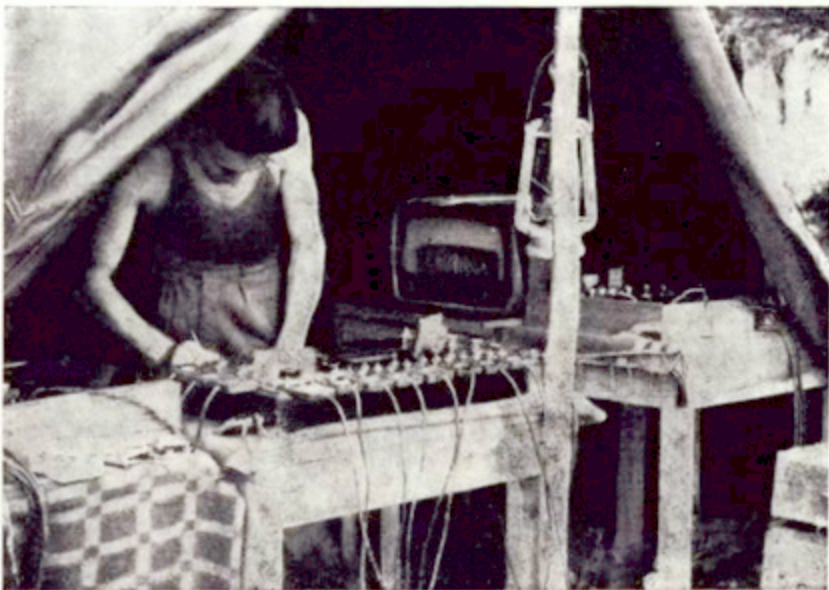
Fot. 3. Odczytywanie temperatury na stacji centralnej. Na pierwszym planie aparatura odbiorcza oraz kable łączące miliwoltomierz z termometrami oporowymi; w głębi radiodbiornik dla przyjmowania sygnałów czasu i prognoz pogodowych
