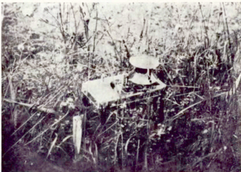
Fot. 4. Termometr kompleksowy. Widoczna osłona przed promieniowaniem słońca, poczerniona kulka oraz osłonka muślinowa termometru zwilżonego
