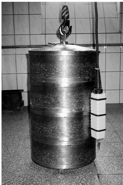
Ryc. 8. Zestaw koszyków do termoterapii żołądźi (Wytłuszczarnia Siedlisko n. Odrą, Nadleśnictwo Nowa Sól)
