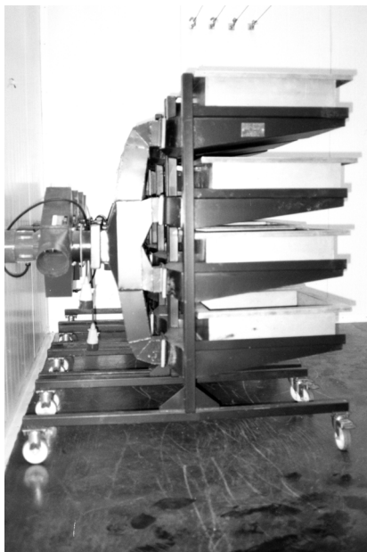
Ryc. 13. Tace do zmrażania żołądzi, ciepłych jeszcze po termoterapii i zaprawieniu, za pomocą strumienia powietrza o temperaturze -3^{\circ}\text{C} przed ich umieszczeniem w pojemnikach do przechowywania. Fungicyd jest przechwytywany przez filtry (Szkółka Nędza, Nadleśnictwo Rudy Raciborskie)
