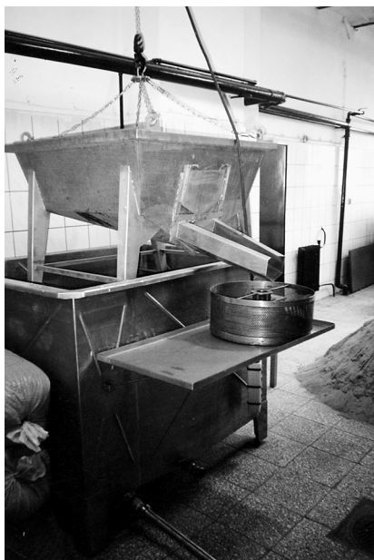
Ryc. 5. Wanna do spławiania żołądzi z koszem wyciągniętym z wody za pomocą elektrowciągu. Na frontowej ściance kosza założono rynnę do napełniania koszyków do termoterapii (Wyluszcarnia Siedlisko n. Odrą, Nadleśnictwo Nowa Sól)
