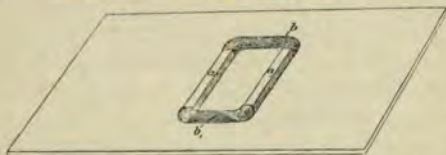
Rys. 5. Szkiełko przedmiotowe do drażnienia prądem galwanicznym istot mikroskopowych: a, a —wałki z wypalonej gliny, b, b —wałki izolujące.
