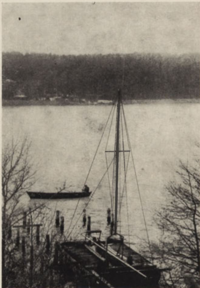
Fot. 1. Zestaw do wydobywania osadów dennych (sonda rdzeniowa, winda z masztem wyciągu i urządzenia pomocnicze), zmontowany na pływającej platformie
