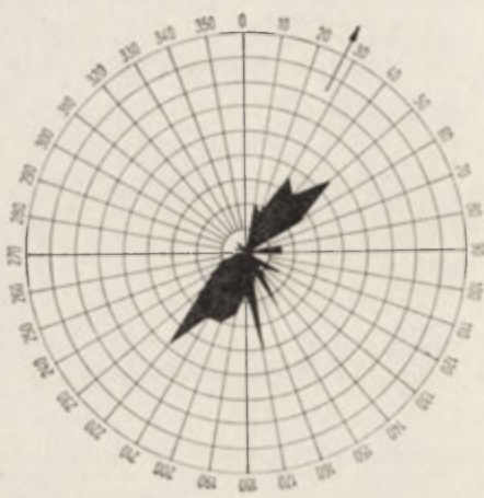
Ryc. 24. Sławęcín. Orientacja dłuższych osi kamieni w górnej glinie ablacyjnej Strzałka wskazuje kierunek nachylenia warstw
