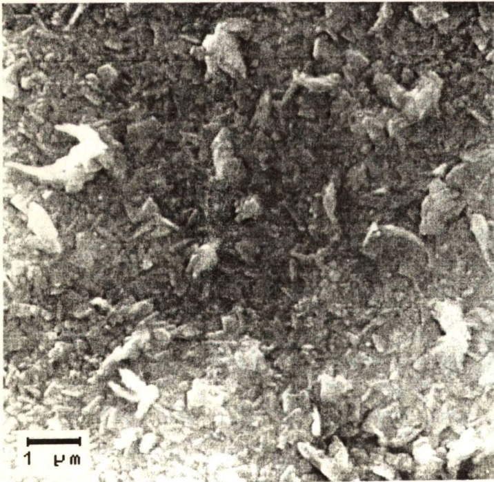
Rys. 12. Niejednorodna fazowo struktura PcCu. Temperatura podłoża 400°C.
