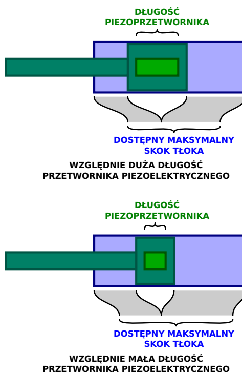
Rysunek 3.1. Ograniczenie skoku tłoka spowodowane zastosowaniem zaworu ze względnie długim przetwornikiem piezoelektrycznym
