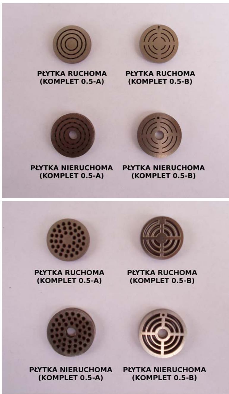
Rysunek 4.18. Zestawienie dwóch kompletów płytek zaworowych. U góry: widok powierzchni wzajemnego styku płytek. U dołu: widok od strony przeciwnej do powierzchni styku płytek.
