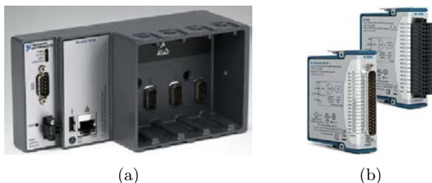
Rysunek 3.17. Elementy układu akwizycji danych: (a) kontroler cRIO NI 9075, (b) karty pomiarowe NI 9205.
