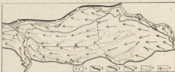
Ryc. 10. Hipotetyczne kierunki ruchu wód gruntowych w Puszczy Kampinoskiej 1 — wydmy w których obserwowano wody gruntowe, 2 — zbocze wysoczyzny morenowej, 3 — zbocze erozyjno-denudacyjnego poziomu błońskiego, 4 — zbocze akumulacyjnego tarasu kampinoskiego, 5 — granice pasów wydmy i bagienne, 6 — hipotetyczne kierunki ruchu wód gruntowych
