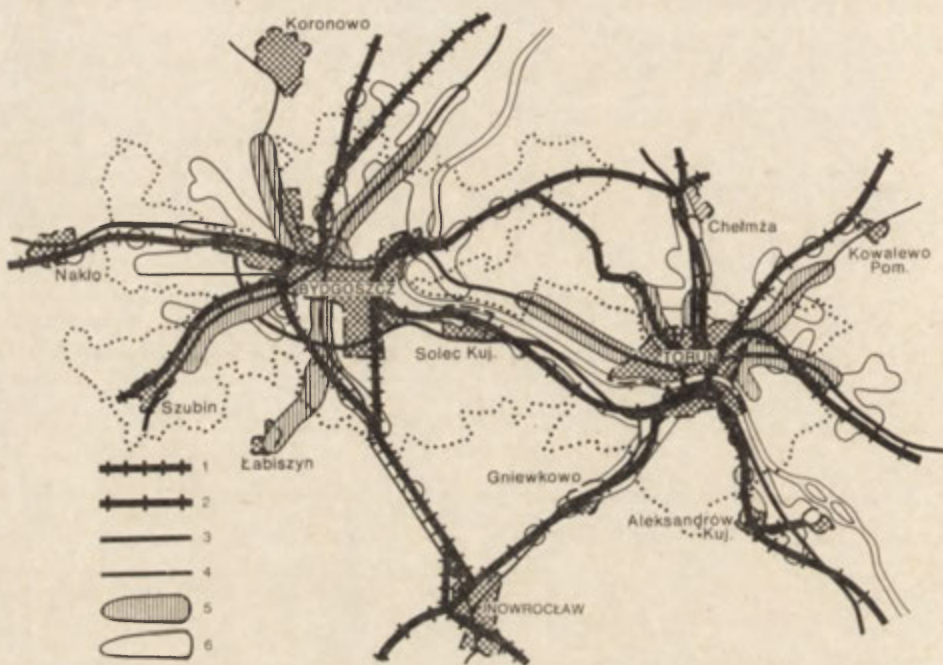
Ryc. 4. Przestrzenny zasięg transportu zbiorowego na obszarze aglomeracji bydgosko-toruńskiej. Oznaczenia: 1 — linie kolejowe, 2 — linie kolejowe zelektryfikowane, 3 — drogi państwowe magistralne, 4 — pozostałe drogi, 5 — pasy obsługi transportowej o częstotliwości wyższej niż 20 min. dla PKS i 40 min. dla PKP w granicach czasu jazdy do 30 min., 6 — pasy obsługi transportowej dla czasu jazdy 30 min. Naniesiona granica oznacza obszar gromad o zaawansowanych procesach urbanizacji wg B. Bańkowskiej (1, 2).
